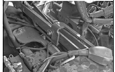
Joonis 74 – Rooli lukustusvarda kang/platvormi kallutamise klamber
