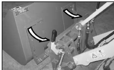
Joonis 55 – Hüdraulilise Power-A-Tach® süsteemi haakeseadise eemaldamine
